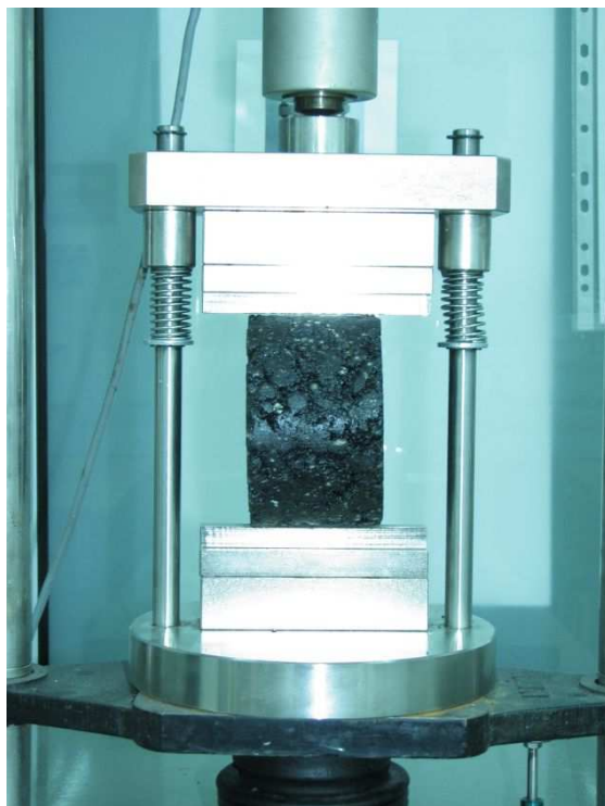
Rys. 4-69. Sposób ustawienia próbki Marshalla w szczękach do badania wytrzymałości na rozciąganie pośrednie
