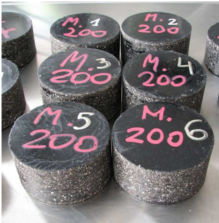
Rys. 4-46. Próbkki analityczne mastyksu izolacyjnego po wygrzewaniu w temperaturze 200°C przygotowane do badań (widoczna dolna powierzchnia próbek)
