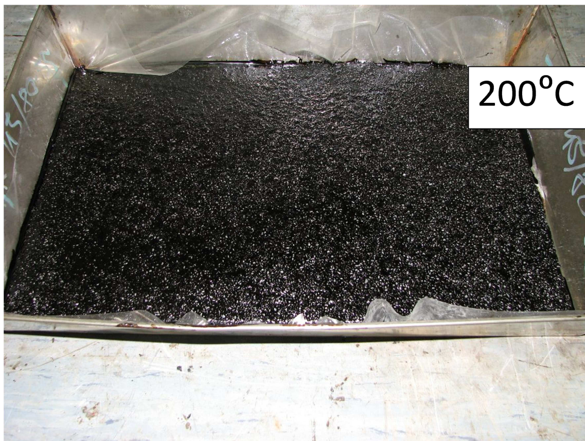
Rys. 4-28. Papa mostowa wygrzewana przez 1 godzinę w temperaturze 200°C
