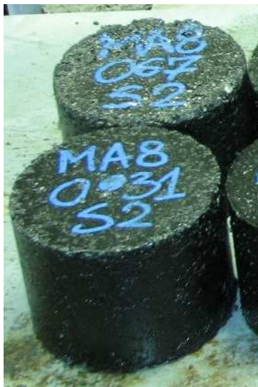
Rys. 5-5. Próbkę asfaltu lanego MA 8 po starzeniu STOA przygotowane do badań
