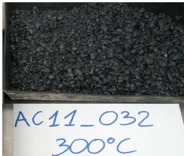
Rys. 4-75. Beton asfaltowy z polimeroasfaltem PmB 25/55-60 wygrzewany przez 1 godzinę w temperaturze 300°C
