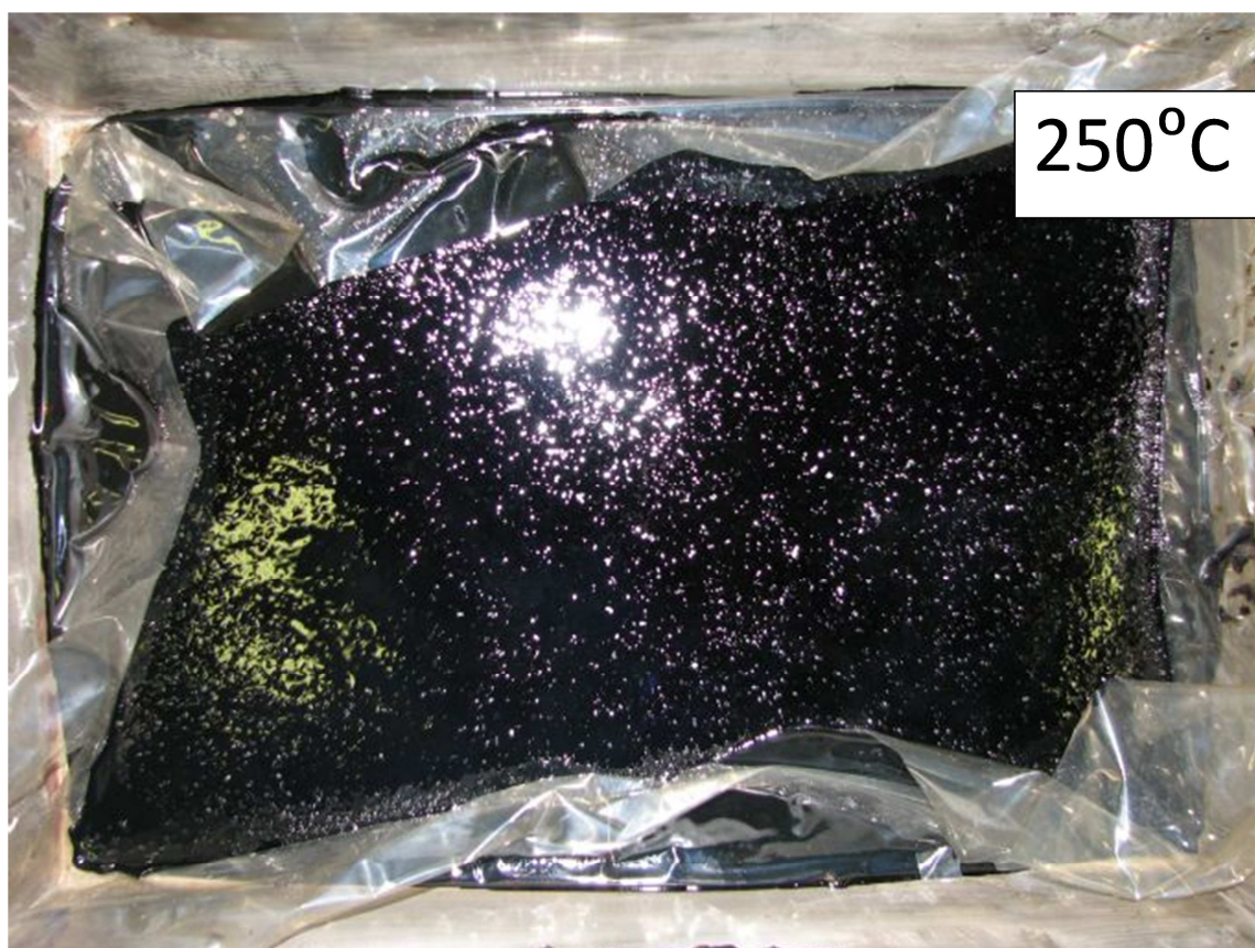
Rys. 4-31. Papa mostowa wygrzewana przez 1 godzinę w temperaturze 250°C
