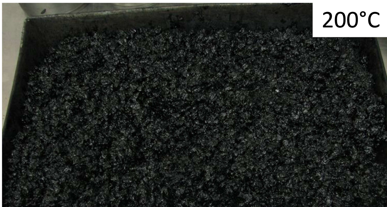
Rys. 4-55. Mastyks wysokogrysowy SMA/MA 8 z polimeroasfaltem wygrzewany przez 1 godzinę w temperaturze 200°C
