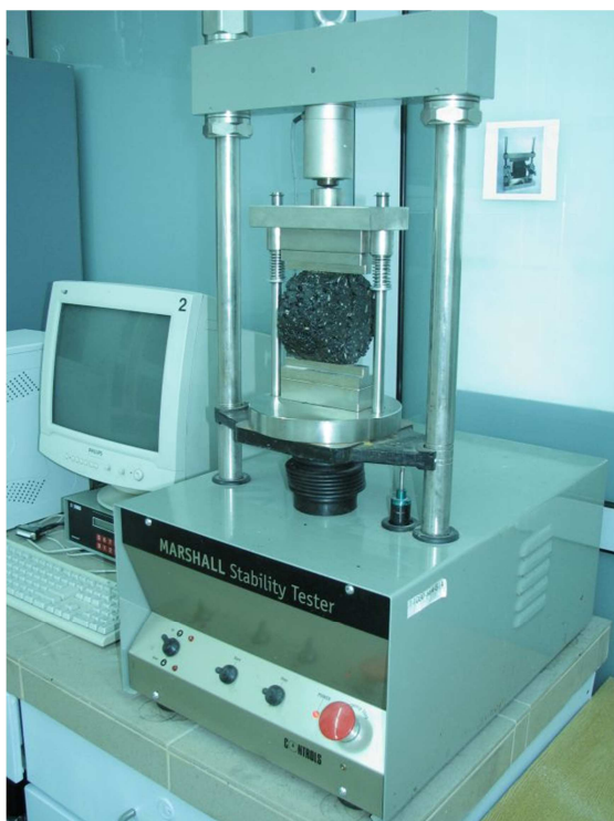
Rys. 4-68. Prasa Marshalla z przystawką do badania wytrzymałości na rozciąganie pośrednie
