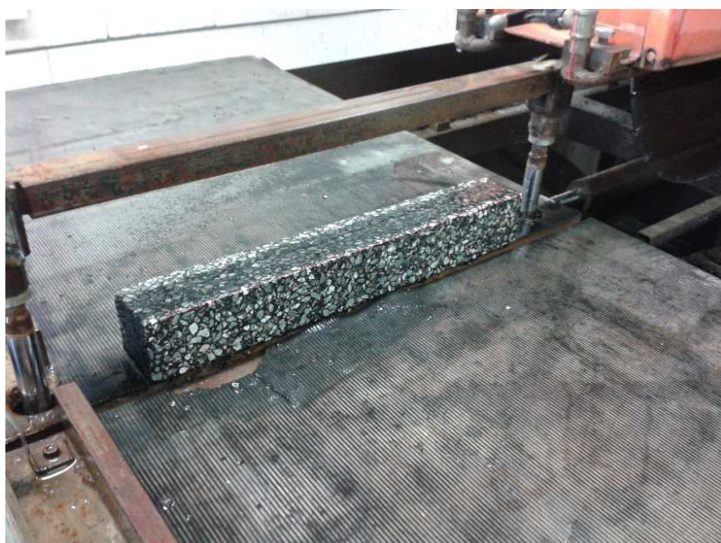
Rys. 4-81 Widok wyciętej próbki z zagęszczonej płyty z mieszanki mineralno-asfaltowej
