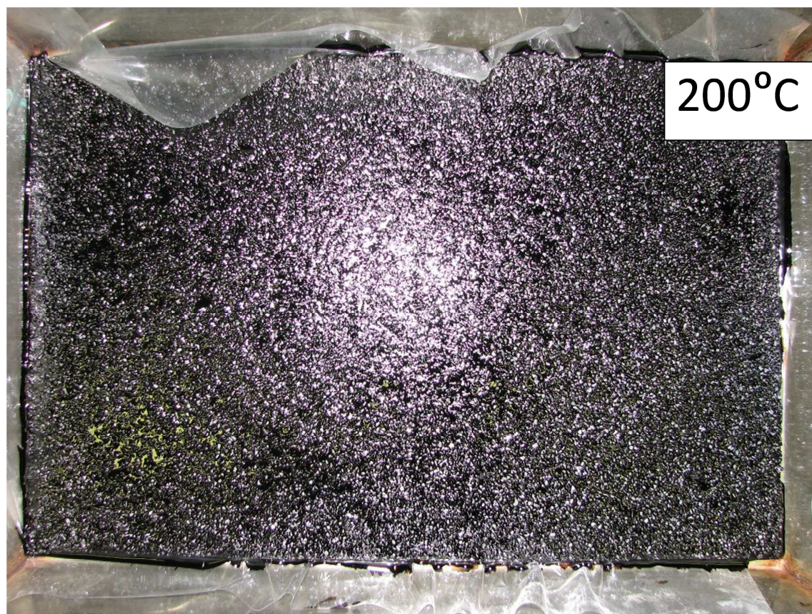
Rys. 4-29. Papa mostowa wygrzewana przez 1 godzinę w temperaturze 200°C
