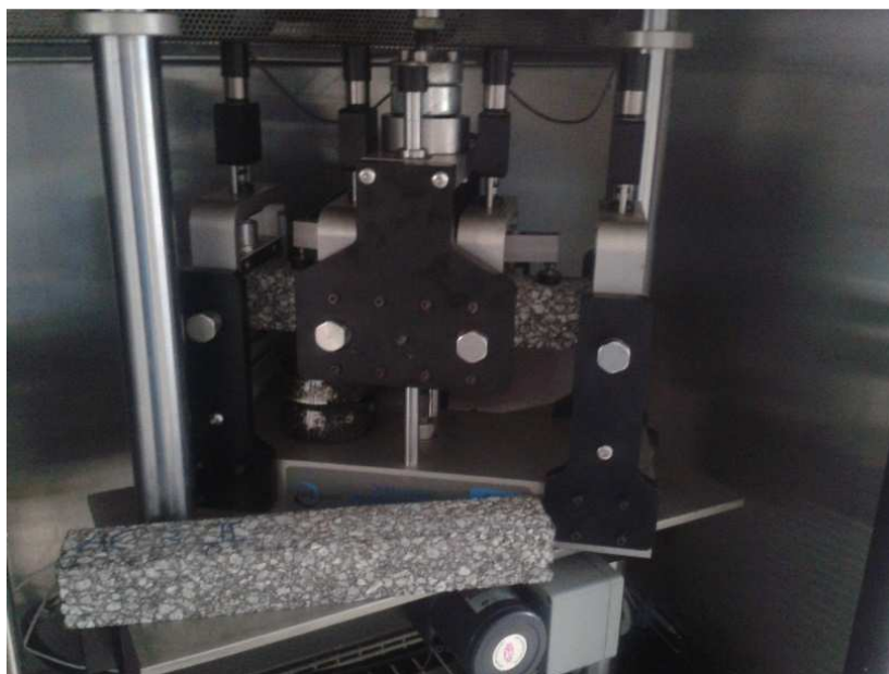
Rys. 4-83 Widok próbki belkowej umieszczonej w aparacie pomiarowym
