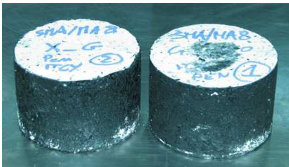
Rys. 4-54. Próbki mastyksu wysokogrysowego SMA/MA 8 z lepiszczem gumowo-asfaltowym przed wygrzewaniem (z lewej strony) oraz po wygrzewaniu w temperaturze 300°C przygotowane do badań
