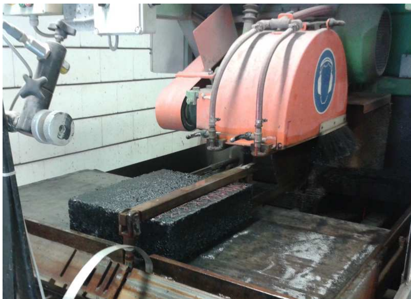
Rys. 4-80 Widok wycinania próbek z zagęszczonych płyt z mieszanki mineralno-asfaltowej
