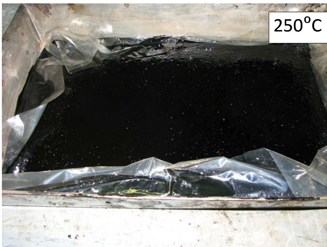
Rys. 4-30. Papa mostowa wygrzewana przez 1 godzinę w temperaturze 250°C
