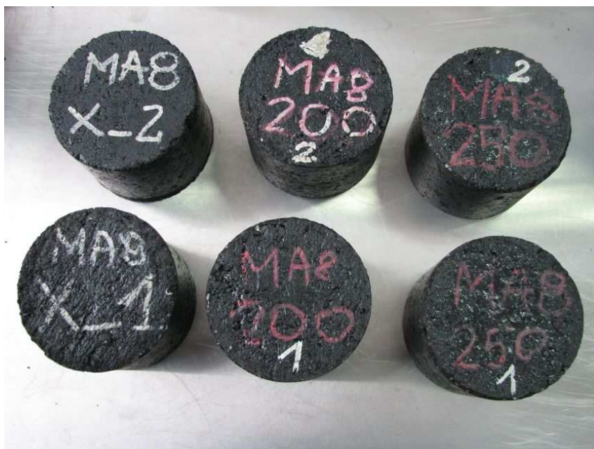
Rys. 4-36. Próbkę asfaltu lanego MA 8 nie wygrzewane oraz po wygrzewaniu w temperaturze 200 i 250°C przygotowane do badań
