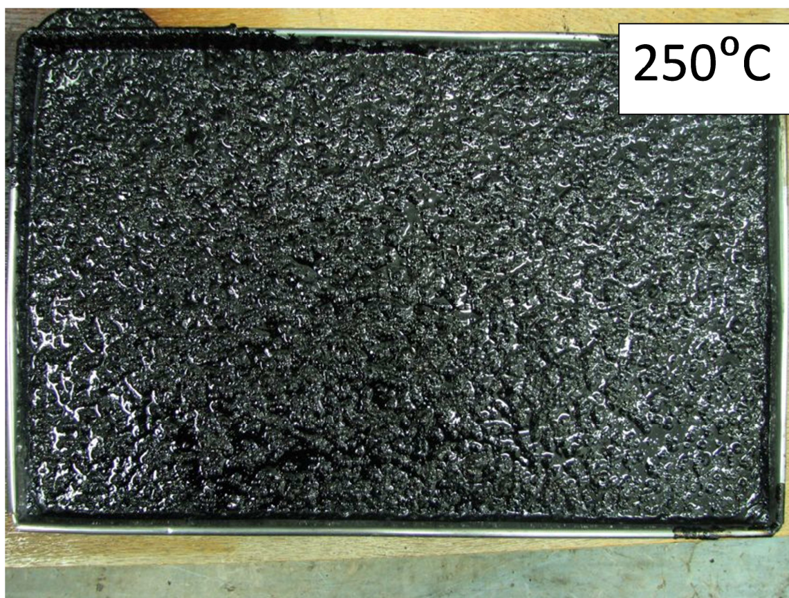
Rys. 4-40. Asfalt lany wygrzewany przez 1 godzinę w temperaturze 250°C
