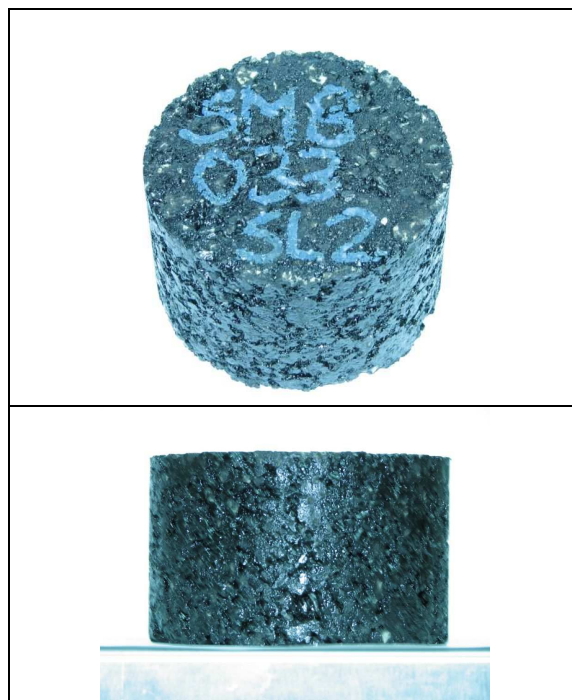
Rys. 5-23. Mastyks wysokogrysowy SMA 8 z polimeroasfaltem PmB 45/80-55 po starzeniu długoterminowym LTOA
