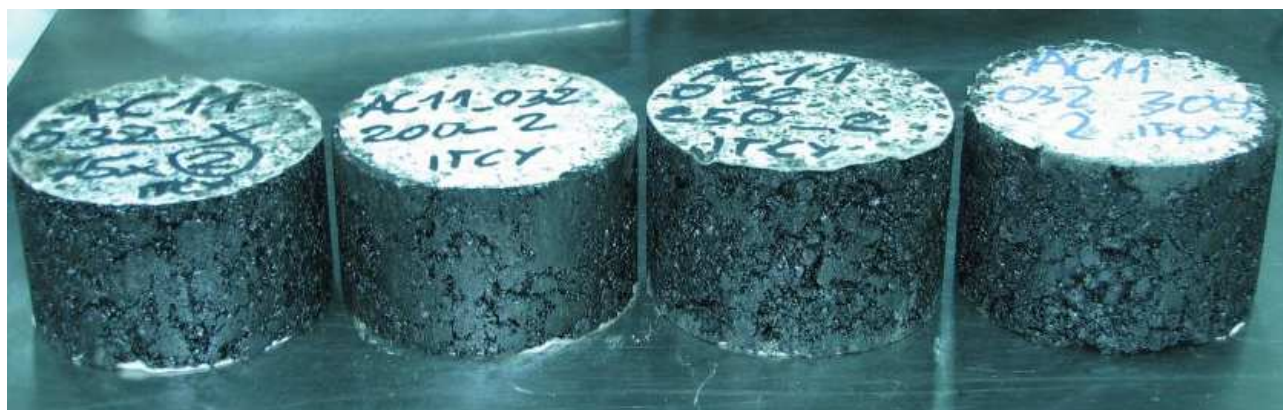
Rys. 4-73. Próbki betonu asfaltowego AC 11 z polimeroasfaltem PmB 25/55-60 przed wygrzewaniem oraz po wygrzewaniu w temperaturze 200, 250 i 300°C przygotowane do badań
