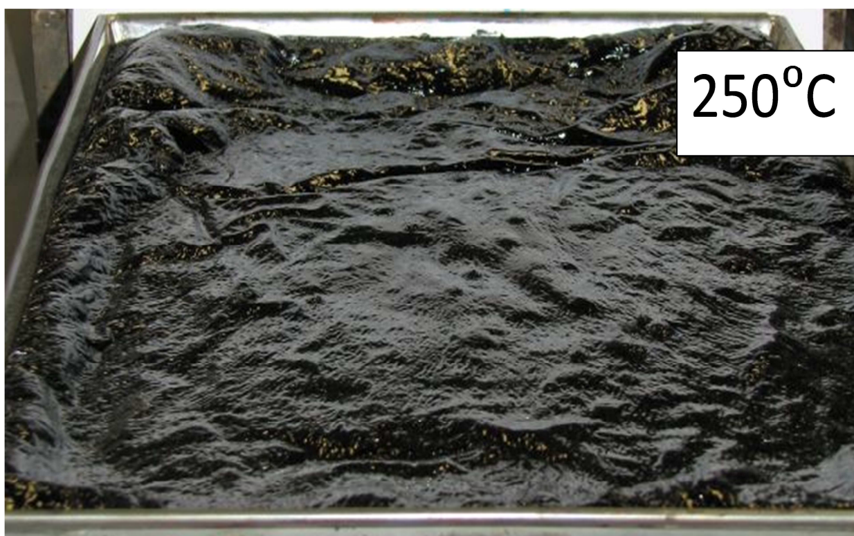
Rys. 4-49. Mastyks izolacyjny wygrzewany przez 1 godzinę w temperaturze 250°C
