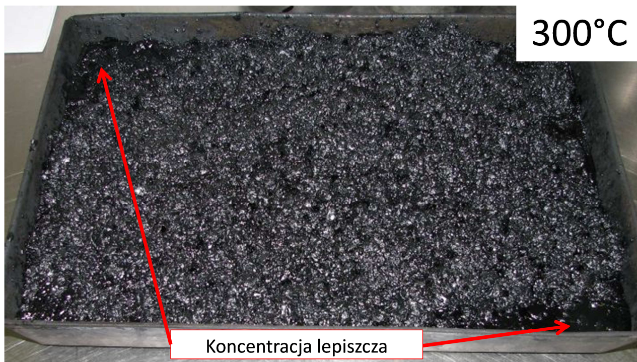
Rys. 4-57. Mastyks wysokogrysowy SMA/MA 8 z polimeroasfalem wygrzewany przez 1 godzinę w temperaturze 300°C
