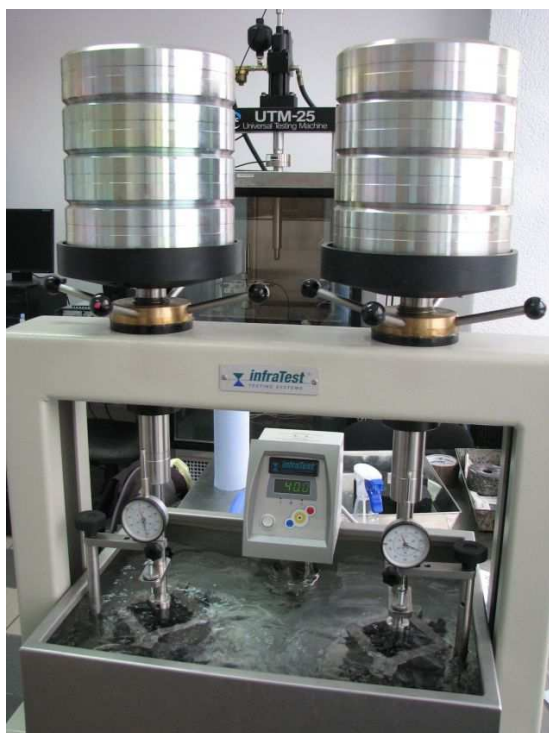
Rys. 4-37. Penetrometr dwustanowiskowy do badania twardości asfaltu lanego i mastyksu tradycyjnego
