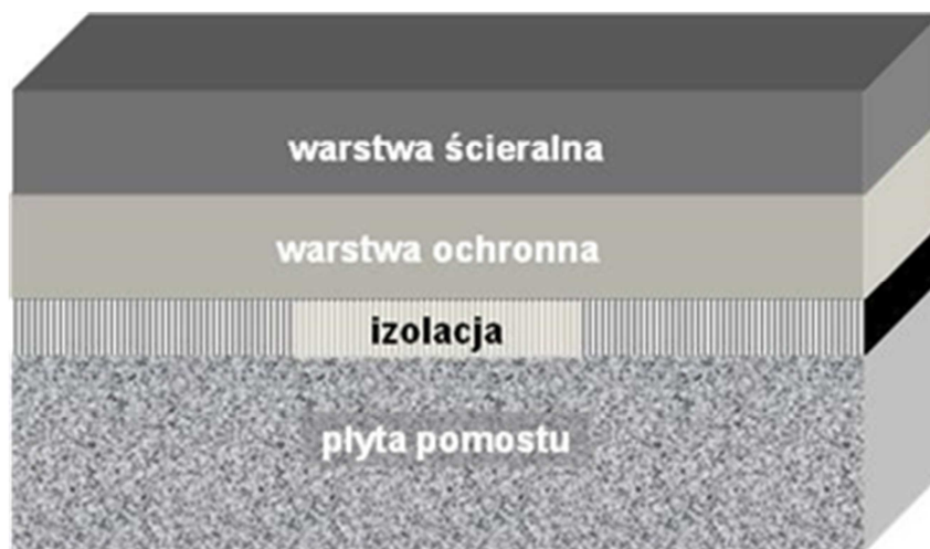
Rys.1-1. Układ warstw konstrukcji nawierzchni na pomoście [6]
