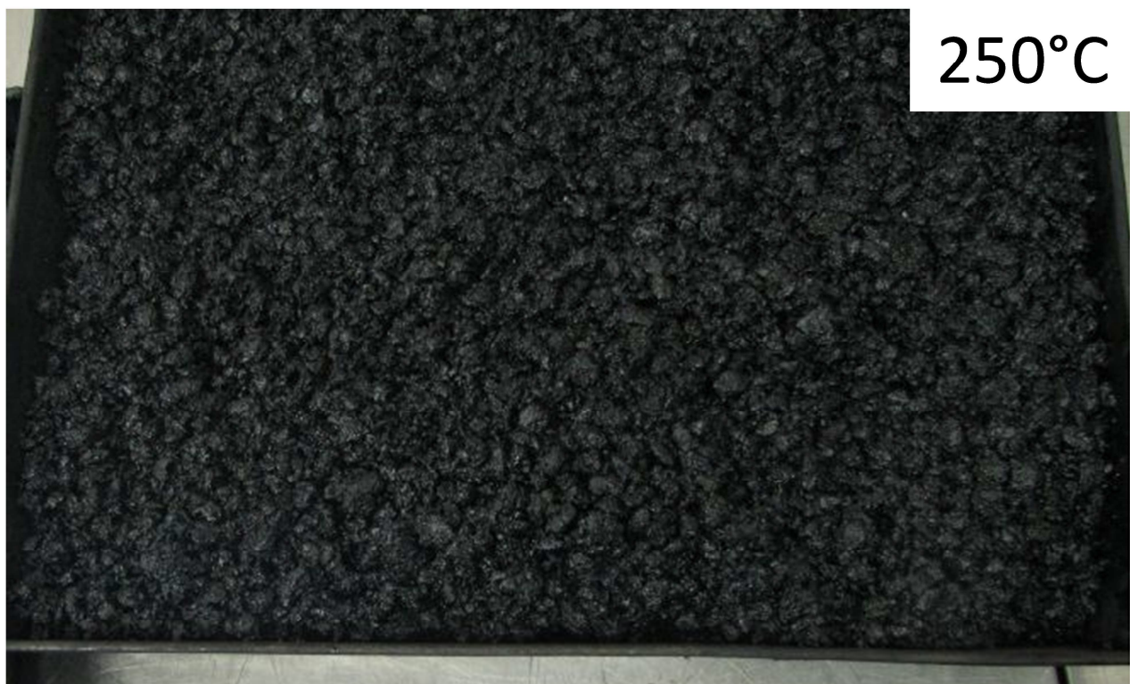
Rys. 4-56. Mastyks wysokogrysowy SMA/MA 8 z polimeroasfaltem wygrzewany przez 1 godzinę w temperaturze 250°C
