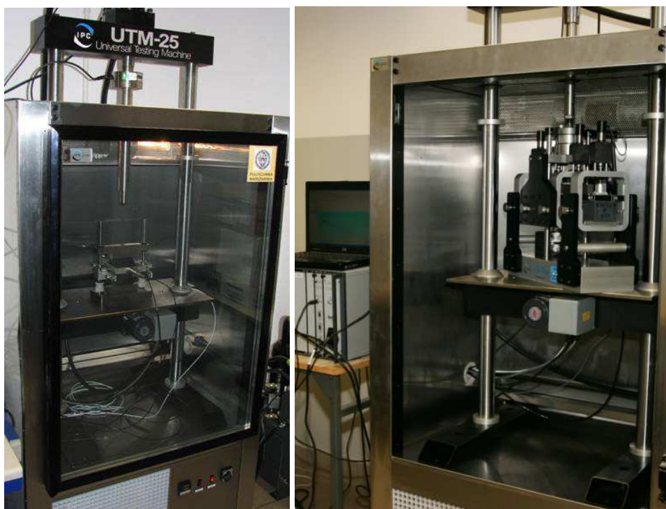
Rys. 4-79 Uniwersalne urządzenie UTM-25, do badań zmęczeniowych mieszanek mineralno-asfaltowych
