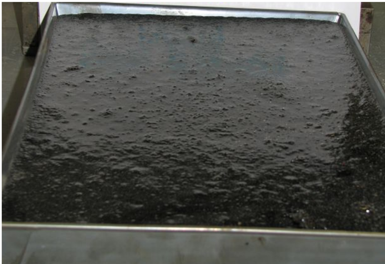
Rys. 4-47. Mastyks izolacyjny nie poddany wygrzewaniu
