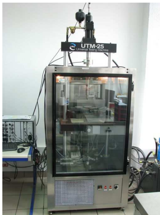
Rys. 4-38. Uniwersalna hydrauliczna maszyna wytrzymałościowa do badania modułu sztywności mma
